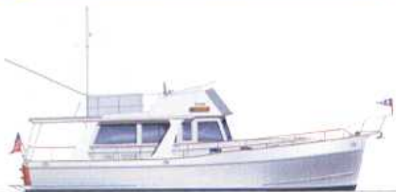
L'esthétique a dû parfois céder au sens pratique. Ainsi, la main courante en inox remplace la traditionnelle main courante en teck, exigeante en entretien.
