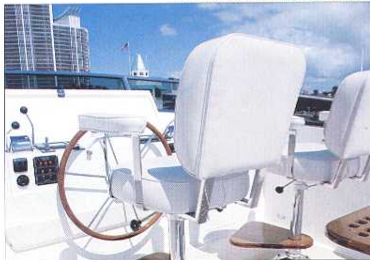
L'esthétique a dû parfois céder au sens pratique. Ainsi, la main courante en inox remplace la traditionnelle main courante en teck, exigeante en entretien.
